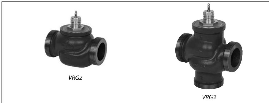
Сідельні регулювальні клапани **VRG2** (двохходові), **VRG3** (трьохходові) застосовуються з редукторними електричними приводами типу **AMV435**, що керуються імпульсним сигналом та типу **AME435**, які можуть використовуватися з будь-яким різновидом аналогового керуючого сигналу (0(2)...10 В чи 0(4)...20 мА) для регулювання витрати тепло- / холодоносія в системах опалення та охолодження відповідно.
