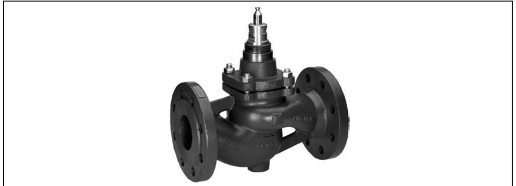
Сідельні регулювальні клапани VFS2 із логарифмічною витратною характеристикою застосовуються в основному для регулювання витрати теплоносія в системах централізованого теплопостачання (теплові мережі, теплові пункти, тощо), а також в системах паропостачання з температурою пари до +200 °С. Крім того, вони також можуть бути застосовані в системах централізованого холодопостачання для регулювання витрати холодоносія температурою від -10 °С.
