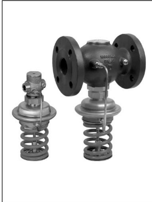
AVA – це автоматичні регулятори тиску «до себе» прямої дії, які використовуються в першу чергу в системах централізованого теплопостачання, зазвичай в якості регуляторів підпору. Регулятор AVA складається із регулювального клапану, регулювального елемента з однією мембраною та пружиною (пружинами) налаштування та однієї імпульсної трубки. Клапан регулятора нормально закритий та відкривається при зростанні тиску перед регулятором.
