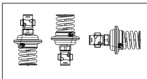
При температурі регульованої середи більше 100 °C регулятори повинні бути встановлені тільки на горизонтальних трубопроводах регулювальним елементом донизу.
